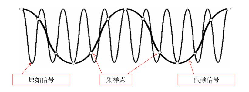
采样频率 = 120Hz, 奈奎斯特频率 = 60Hz < 100Hz = 原始信号频率
